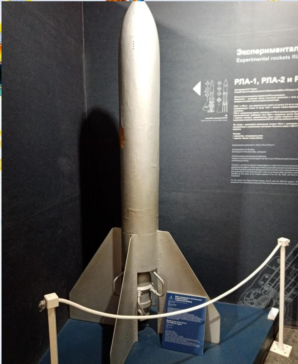
В музее представлен макет реактивного летательного аппарата РЛА – 2 с двигателем ОРМ – 52.
